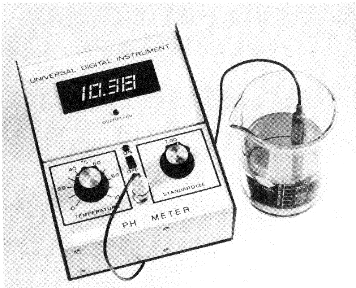
Fig. 7-10. Digital pH meter using a 3130 op amp.
