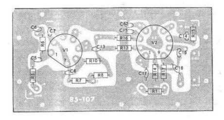
RF-OSCILLATOR-MIXER CIRCUIT BOARD #85-107P149
