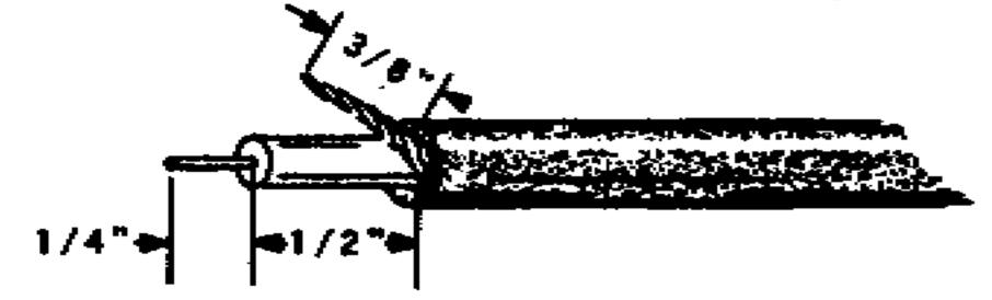
2) SOLDER THE SHIELD LEAD AND THE CENTER LEAD TO THE PHONE JACK. THEN PINCH THE CLAMPS AROUND THE CABLE.
